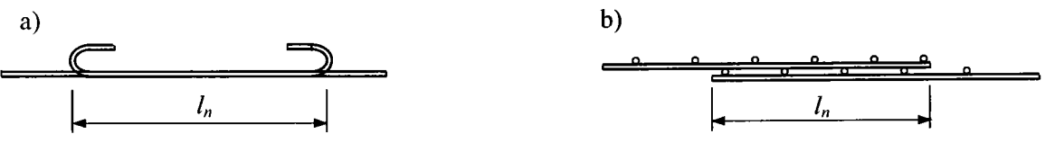
Hình 2.5. Nối buộc cốt thép a) Nối thép thanh; b) Nối thép lưới.
