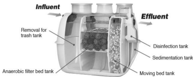
Hình 2.4. Sơ đồ mô hình xử lý nước thải Johkasou
